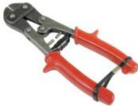
Utilizado para cortes nos arames dos módulos (quando necessário): em curvas, mudança de direção, abertura para passagem de tubulação, etc.
